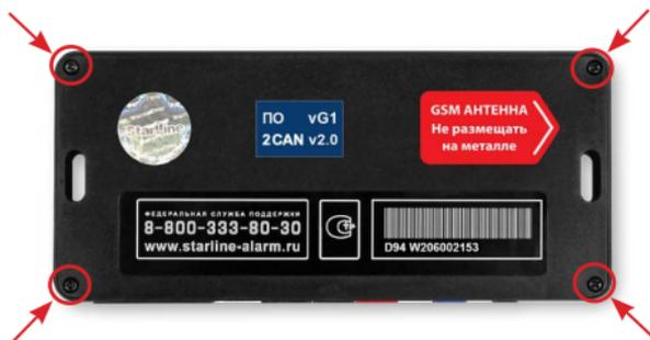
2) Извлеките плату центрального блока. Установите SIM-карту в GSM модуль до упора в направлении, указанном стрелкой на рисунке.
