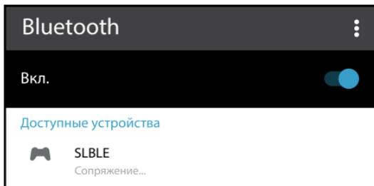
7. Последуют подтверждающие сигналы сирены. Количество сигналов будет соответствовать количеству подключенных устройств. Устройство с именем SLBLE отобразится в списке сопряженных устройств на экране мобильного телефона.
