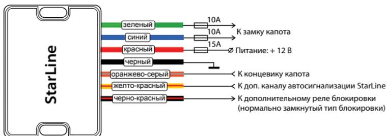
**Зеленый провод, синий провод** – силовые релейные выходы управления электроприводом замка капота. В нормальном состоянии на этих выходах присутствует «масса» (схему контактов встроенных реле см. ниже). Для запираии замка капота – на зеленом проводе появляется +12 В на 0,8 сек. Для отпирании замка капота – на синем проводе появляется +12 В на 0,8 сек.
