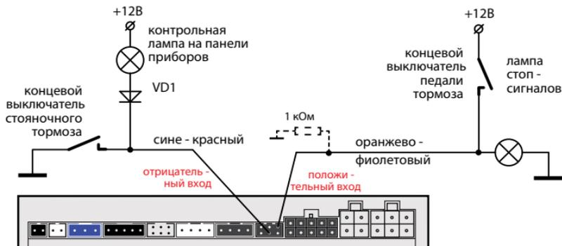
При подключении к стояночному тормозу необходимо подключить диод (VD1 - 1N4007) в разрыв штатного провода стояночного тормоза и подсоединить вход автосигнализации между катодом диода и концевым выключателем.
