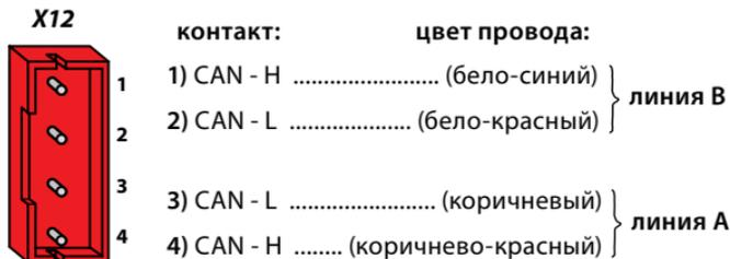
Информацию о подключении и функциональных возможностях CAN интерфейса для Вашего автомобиля см. на странице [can.starline.ru](http://can.starline.ru)
