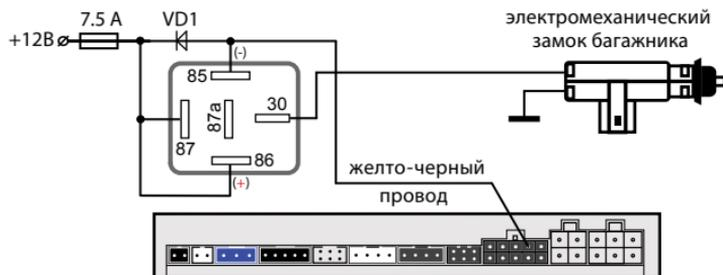
В этой схеме для открывания багажника используется доп. канал №1 (желто-черный провод разъема X3). При подключении необходимо использовать дополнительное реле, а программируемую функцию 14 настроить в вариант 1 (см. стр. 44).
