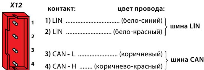
Информацию о подключении и функциональных возможностях LIN интерфейса для Вашего автомобиля см. на странице [can.starline.ru](http://can.starline.ru)
