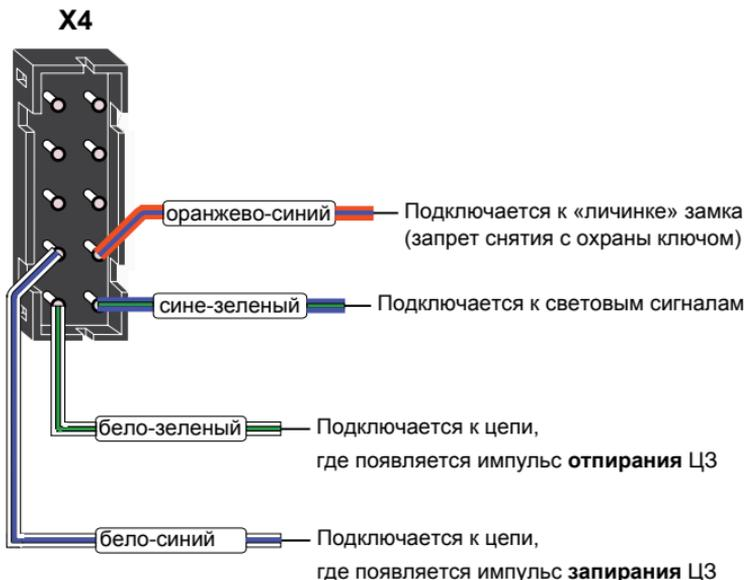
**Бело-зеленый и бело-синий провода разъема X4** подключаются к штатному проводу подачи питания на электропривод замка двери автомобиля. Полярность входов программируется. Запрограммируйте функцию 18 таблицы №1 на необходимый вариант согласно полярности управляющего импульса, подающегося в цепь питания электропривода автомобиля.
