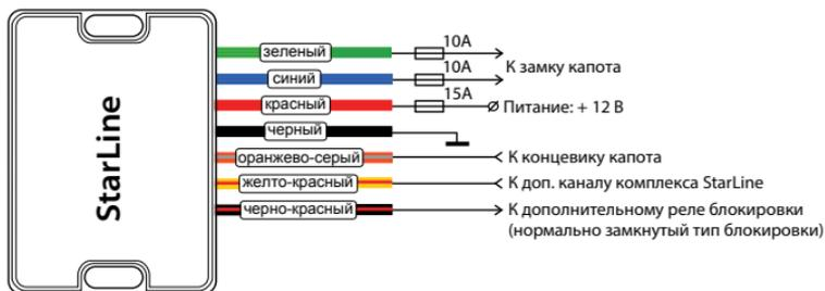
**Зеленый провод, синий провод** – силовые релейные выходы управления электроприводом замка капота. В нормальном состоянии на этих выходах присутствует «масса» (схему контактов встроенных реле см. ниже). Для запираии замка капота – на зеленом проводе появляется +12 В на 0,8 сек.
