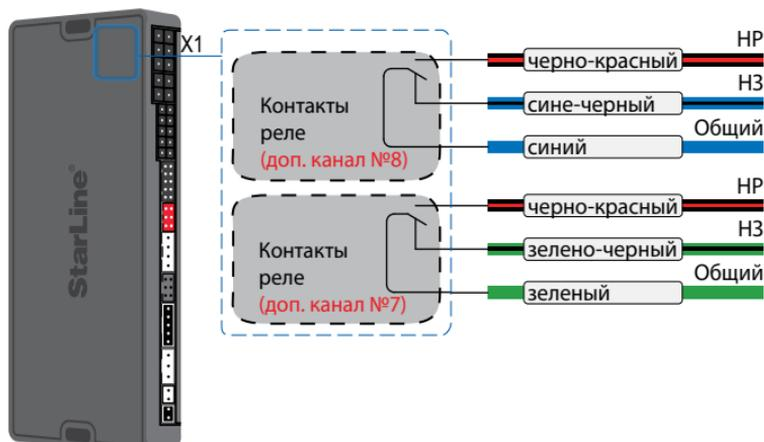
Выход доп. канала №9 представляет собой два контакта силового реле управления световыми сигналами. Выходной сигнал положительный +12 В. Максимальным допустимым ток на каждый выход 7,5 А.
