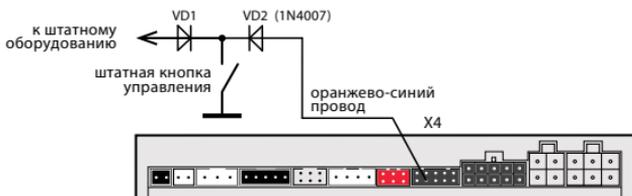
**Подключение входа событий №1 к штатной кнопке автомобиля, замыкающейся на +12 В :**
