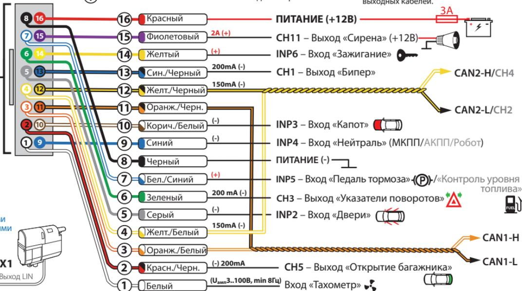
**ВНИМАНИЕ!** Все силовые цепи с использованием внешних реле и других исполнительных устройств, не питающихся от базового блока системы, должны иметь свои предохранители в цепи питания.
