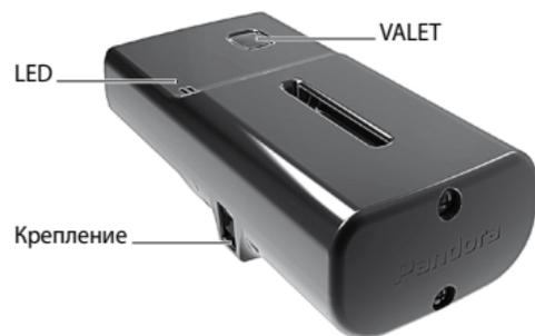
**Встроенный GSM(2G/3G/4G LTE) модем** - обеспечивает обмен данными для работы с удалённым сервером (поддержка сайта pro.p-on.ru и мобильных приложений Pandora Online, Pandora Pro), управление с помощью СМС-сообщений, отправка СМС-сообщений и PUSH-уведомлений по настроенным событиям, автоматическое определение даты и времени.
