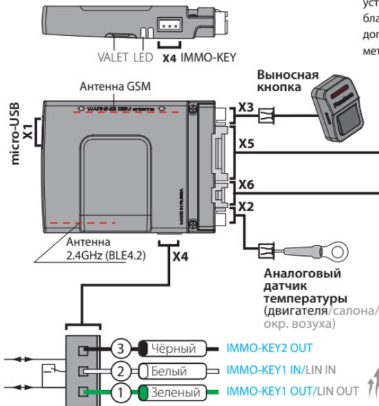
Разъём X4 – используется для обхода штатного иммобилайзера (подключается согласно карте установки размещённой на сайте loader.alarmtrade.ru или в программе Pandora AlarmStudio) или для управления цифровыми подогревателями Webasto Thermo Top Evo, Eberspacher Hydronic 1/1/2/3 (Пункт 3.5.1 Использовать IMMO-KEY порт как LIN).
