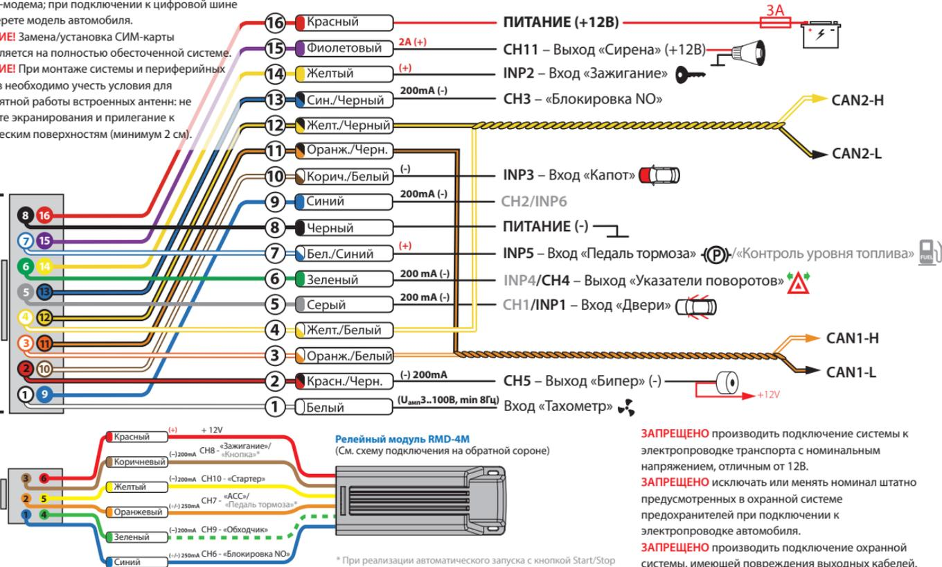
**ЗАПРЕЩЕНО** производить подключение системы к электропроводке транспорта с номинальным напряжением, отличным от 12В.
